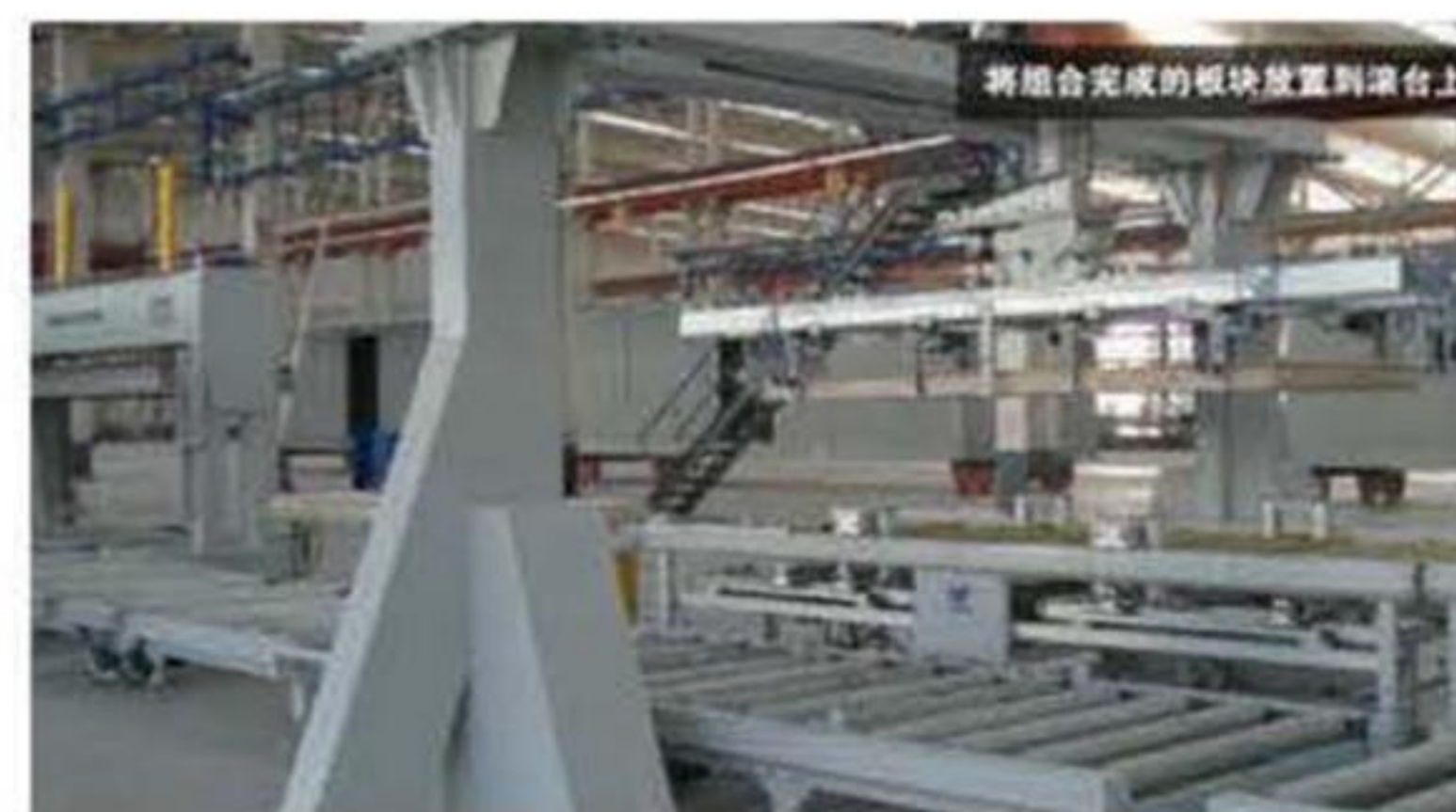
组合完成的墙板放在滚台上
